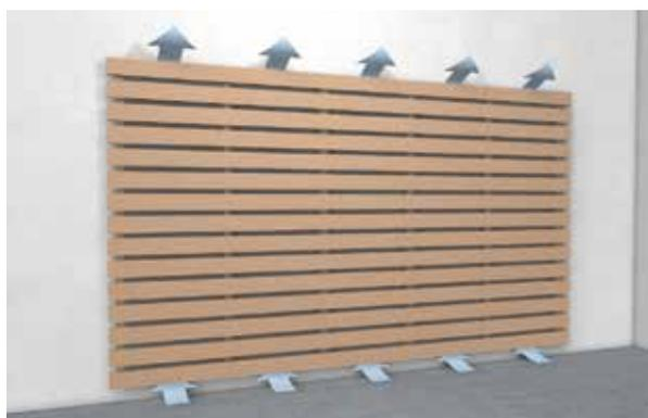
La lame d'air arrière doit être d'au moins 20 mm et ne doit pas être réduite.
