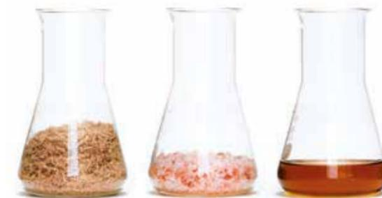
Materiali grezzi utilizzati: c.ca 60% buccia di riso, c.ca 22% sale minerale, c.ca 18% olio minerale
