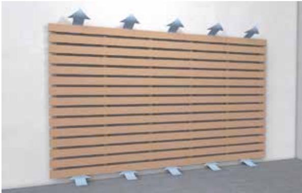
La distancia de ventilación debe ser de al menos 20 mm y no debe reducirse. Las aberturas de ventilación deben tener al menos 20 mm de ancho en todo su perímetro.
